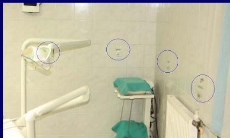
Rozmieszczenie dawkomierzy typu MCP-N w gabinecie stomatologicznym.
